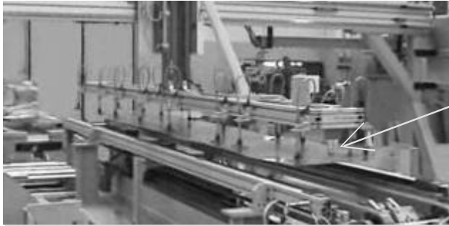
Abb.1 Blechabstapler mit einseitigem, blechberührendem Doppelblech- Sensor
